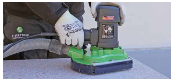
Perfetto complemento alle grandi macchine lucidatrici - soprattutto per la finitura di bordi e piccole superfici
