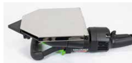
Predisposizione copertura disco per il taglio degli angoli
