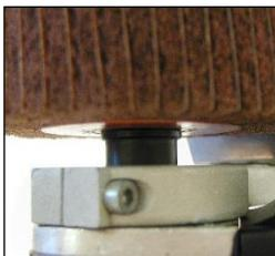
La satinatrice può essere azionata solo se la protezione per le mani è stata applicata. Dopo aver svitato la vite ad esagono cavo M5, la protezione può essere girata nella posizione ottimale per l'applicazione (sempre tra utensile e operatore).
