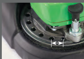
una tacca di arresto corrisponde alla profondità di 0,1 mm
