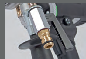
Controllo dell'approvvigionamento idrico
