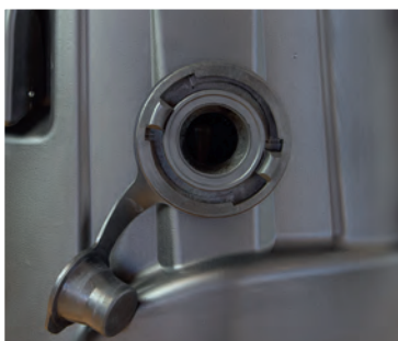
Raccordo a C per le acque reflue
