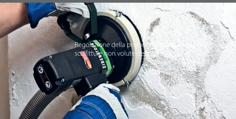
Regolazione della profondità: ghiera regolabile – evita scalfitture non volute della base di lavoro
