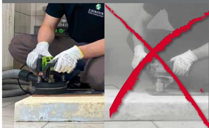
Grazie allo scarico delle polveri l'utilizzatore ha una migliore protezione dalle polveri minerali pericolose, rispetto ai metodi convenzionali con smerigliatrici angolari
