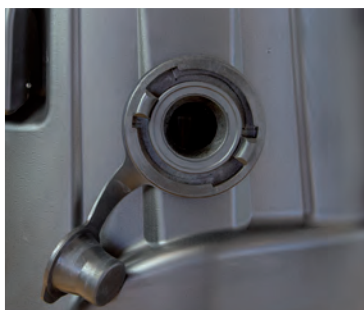
Raccordo a C per le acque reflue
