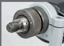
Anello di regolazione della micro percussione
