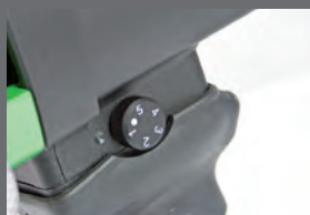
Regolazione della velocità
